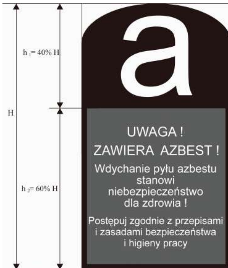
Rys. 4. Wzór prawidłowego oznakowania wyrobów, odpadów i opakowań zawierających azbest oraz miejsc ich występowania.
